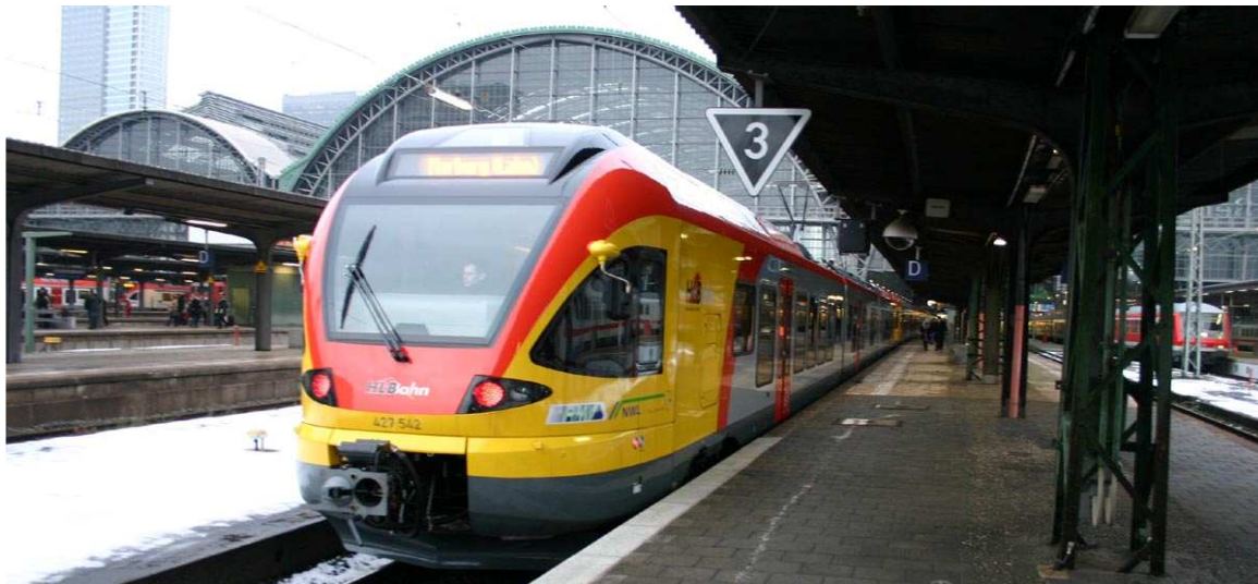
Abfahrtsbereit im Hauptbahnhof Frankfurt für 16:22 Uhr: 13-teiliger HLB-LIRT (3+5+5; Gesamtzuglänge ca. 240 m mit knapp 700 Sitzplätzen) nach Marburg und Siegen; Zugteilung bzw. Zugvereinigung erfolgt in Gießen
