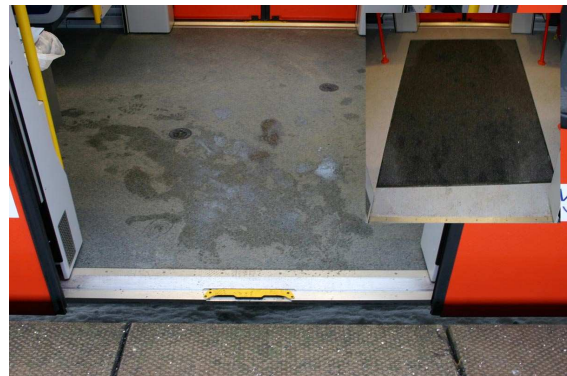
Rutschsicherer Teppichbelag im Einstiegsbereich der VIAS-Züge – wie bei der HLB Standard (kleines Foto) - würde auch Verschmutzungen im Wageninnern minimieren. Allerdings sollte der Teppich den gesamten Einstiegsbereich abdecken
