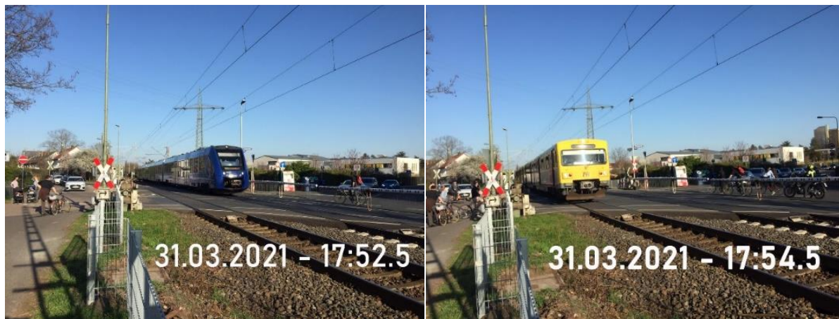
Bilder 5 und 6: Gleiswechselbetrieb auf der „Rebstockstrecke“ am 31. März 2021
